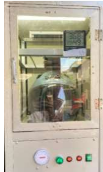
Gambar 4. 2 Helm dikeringkan dengan Lemari Mesin Pengering
