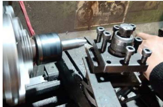
Gambar 4.16 Proses Pembubutan Poros
